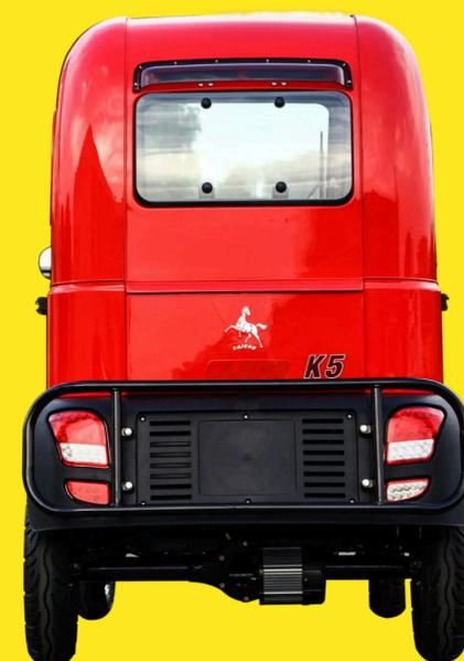
Le véhicule fabriqué par Regal Raptor Motors est un quadricycle qui peut accueillir deux personnes. Le modèle, aussi appelé K5M-2500, mesure 220 x 109 x 163 cm. Il fonctionne avec un moteur de 800 W, une batterie d'une capacité de 2,7 kWh avec un temps de recharge de 8 heures sur une prise 220V. Sa vitesse de pointe est de 40 km/h et son autonomie se limite à 66 km. Son poids à vide est de 258 kg et sa capacité d'emport maximale est de 226 kg.
